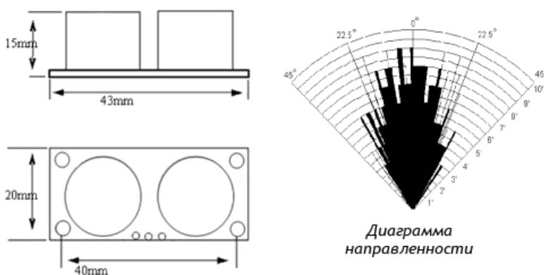
Установить датчик можно на любую ровную вертикальную поверхность, с рекомендуемой высотой от пола 10 -130 см и расстоянием 10-50 см от первой ступени лестницы. Датчик устанавливается строго вертикально относительно стены для исключения ошибки срабатывания при приближении с левой или правой стороны к датчику. Расположение сенсоров датчика может быть как горизонтальным, так и вертикальным. Рекомендуется перед установкой определить наилучшую ориентацию датчика для вашего помещения.
