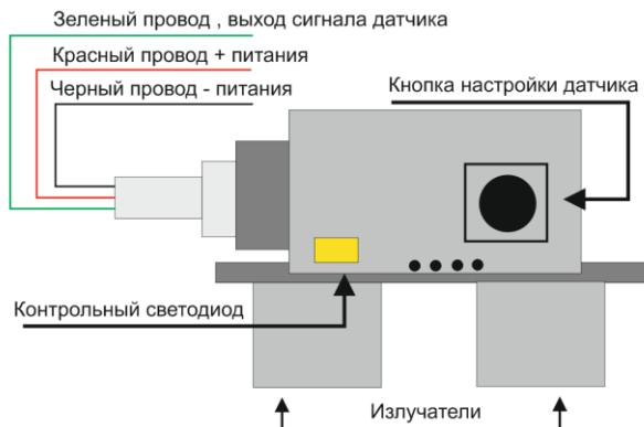
**ВНИМАНИЕ!** Кабеля к датчикам могут иметь цвет проводов отличную указанной на схеме подключения. Просим вас руководствоваться биркой приложенной к комплекту кабелей для правильного подключения датчиков к контроллеру.
