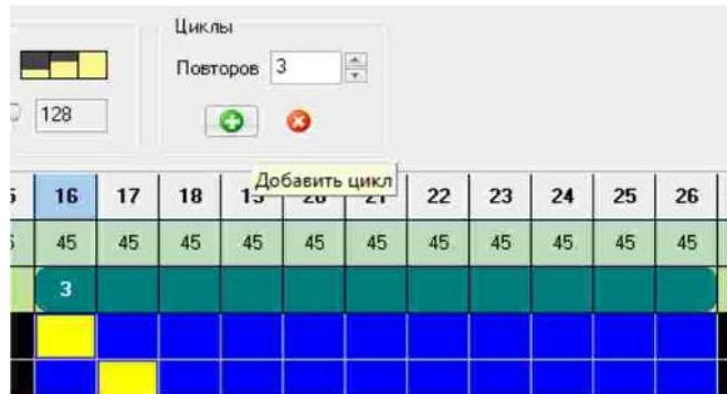
и в панели управления количеством циклов кнопкой добавить цикл и установить требуемое число. Для того чтобы убрать или изменить количество повторов необходимо выделить один из шагов в цикле и изменить число повторов или удалить их кнопкой . Максимальное количество циклов ограничено 32767.
